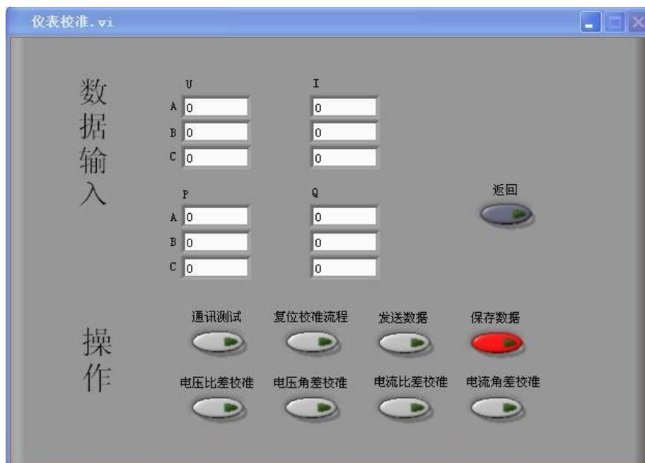
同时，应操作仪器进入校准状态。在校准前应先测试通讯，以验证仪器与 PC 能够进行正常的的数据交换。点击[通讯测试]按钮，仪表发出短音，表明通
