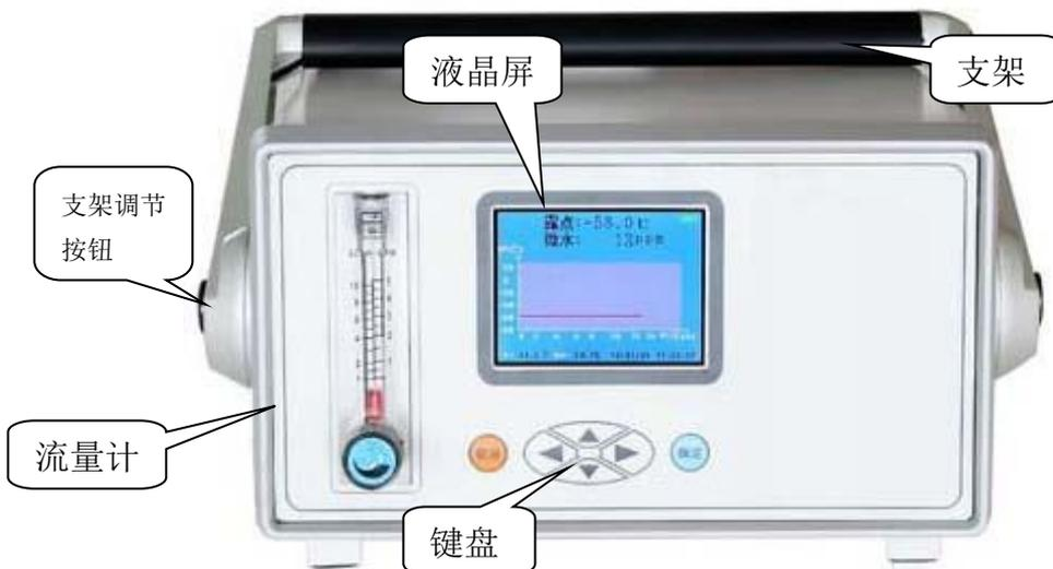
注：同时按下两侧的支架调节按钮，可以调节支架的角度。
