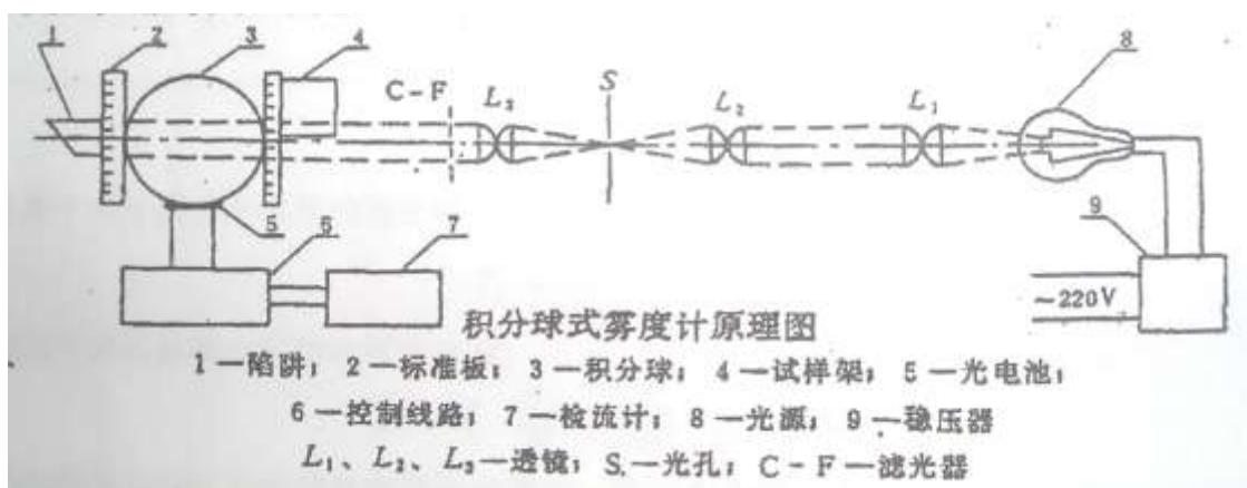
(1) 积分球：用于收集透过的光通量。只要出入窗口的总面积不超过积分球内反射表面积的 1%，任何直径的球都可适用。
