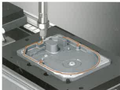
HDD的密封点胶
