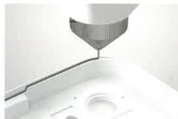
智能手机外壳的PUR密封点胶
