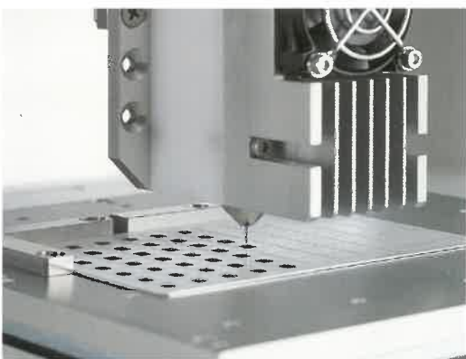
陶瓷基板的封装点胶
