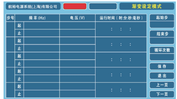
渐变设置页面可设置所需电压、频率、运行时间、初始步、结束步
