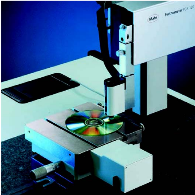
激光传感器的非接触测量
