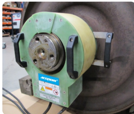
加热用于拆卸的轴承套圈
