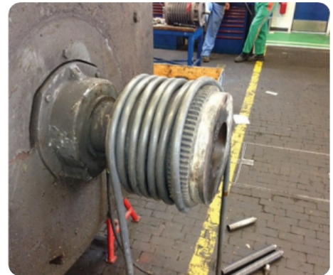
加热联轴器以便拆卸
