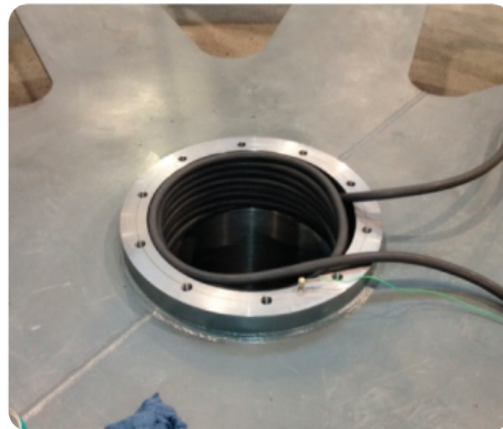
加热用于轴承或轴安装的孔
