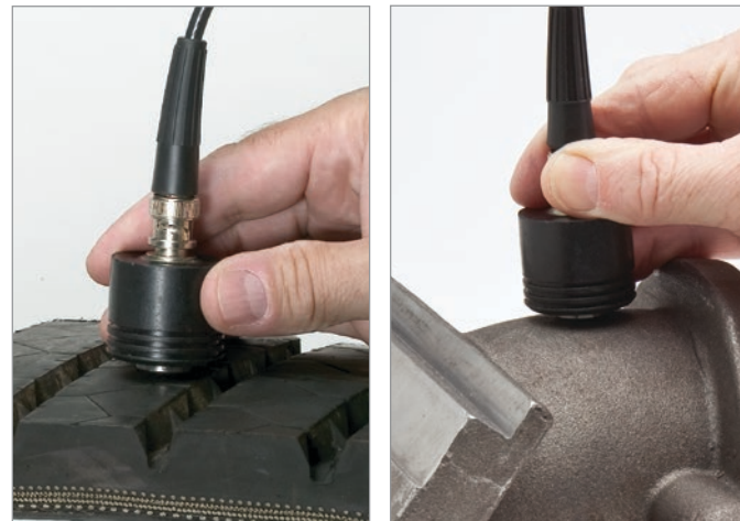
测量橡胶传送带或轮胎中的钢丝帘线的深度
