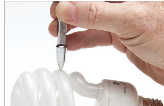
使用V260-SM Sonopen探头对薄玻璃进行测量
