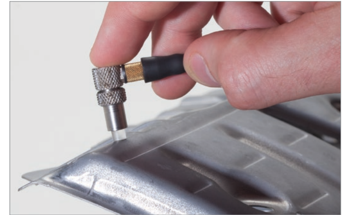
测量金属板因弯曲变形而变薄的情况
