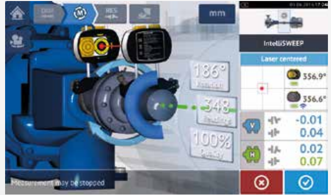
当轴旋转时，测量质量清晰显示 - 绿色或蓝色部分表示良好的测量数据。
