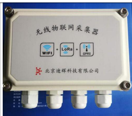
DTU-C3（户外防水型） GPRS+WIFI+RS485+RS232
