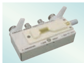
SMD测试治具9263 直接连接型, DC ~ 8MHz, 被 测物尺寸: 1 ~ 10mm
