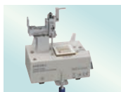
SMD 测试治具IM9100 直接连接型, 底面有电极的SMD 专用, DC ~ 8MHz, 可测量被测 物尺寸: 0402 ~ 1005 (JIS)
