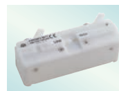
SMD 测试治具9677 直接连接型, 侧面有电极的 SMD专用, DC ~ 120MHz, 被测物尺寸: 3.5 ± 0.5mm
