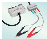
4端子探头 L2000 线长1m, DC ~ 8MHz, 50Ω, 可测量端子直 径: 0.3 ~ 5mm
