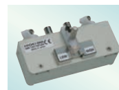
SMD测试治具9699 SMD专用, DC ~ 120MHz, 被测 物尺寸: 宽度1.0 ~ 4.0mm, 高 度1.5mm以下
