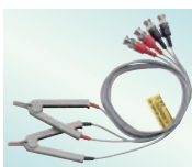
4端子探头9140-10 线长1m, DC ~ 200kHz, 50Ω, 可测量端子直 径: 0.3 ~ 5mm
