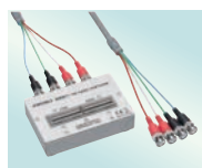
测试治具9261-10 线长1m, DC ~ 8MHz, 可测 量端子直径: 0.3 ~ 1.5mm
