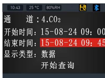
选择查询的类型，按“OK”键选择“全部数据”或“报警数据”。选择“开始查询”，按“OK”键查询，如下图：
