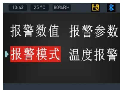
**温度报警:** (选配功能) 可以选择开启或关闭, 默认是关闭状态, 如果设置为“开启”则在气体浓度报警的时候, 第二组继电器无输出, 只有达到设定的温度报警值, 第二组继电器才有输出, 如右图:
