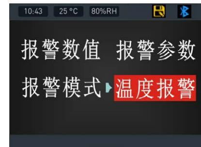
**低温报警:** 低于设定的报警温度就启动第二组继电器输出, 直到温度大于报警温度值与回程差的和, 第二组继电器停止输出, 如右图:
