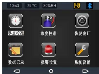
进入零点校准界面后，通过“◀”键和“▶”键选择通道，再按“OK”键进行零点校准，如下图：
