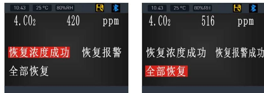
当设置错误或测试浓度不准确时需要进行恢复出厂的操作，如果是人为因素造成的不良可以得到恢复，可以恢复出厂的参数：零点校准值、浓度校准值、报警值、报警方式、报警模式、最大量程。
