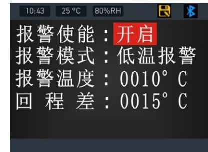
**高温报警:** 高于设定的报警温度就启动第二组继电器输出, 直到温度小于报警温度值减去回程差的值, 第二组继电器停止输出, 如右图:
