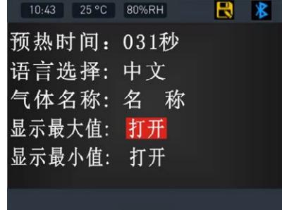
**显示最小值:** 选择打开就在单通道界面显示本次测量的最小值和上次测量的最小值, 如右图:
