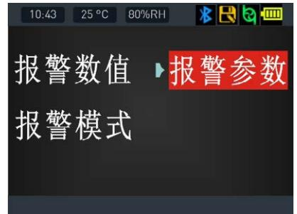
报警方式：可选声光、振动、声光+振
