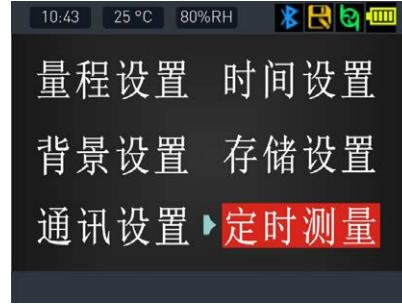
默认的测量时间是0秒, 如果不修改这个数值, 此功能不起作用, 当修改为一定的数值, 此功能开始起作用, 若要使用定时测量的功能。一般情况需要把数值修改为30到60秒, 按泵的开关“PUMP”键开始测量, 达到设定的时间就停止测量, 如右图:
