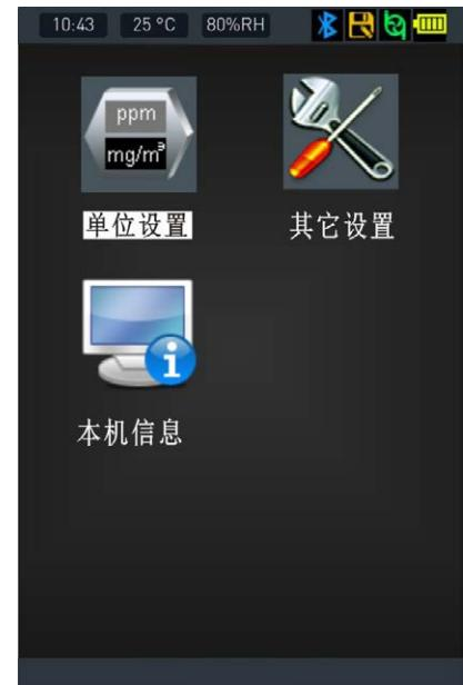
各单位之间自动换算，可以切换的单位：ppm、Vol%、LEL%、ppb、pphm、mg/m<sup>3</sup>、mg/L、g/m<sup>3</sup>，如右图：
