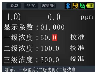
然后通入标准气体或被测气体，将光标移到“校准”位置，再按“ENTER”键校准，如果成功则出现“成功”字样，如果不成功则出现“失败”字样，如右图及下图：
