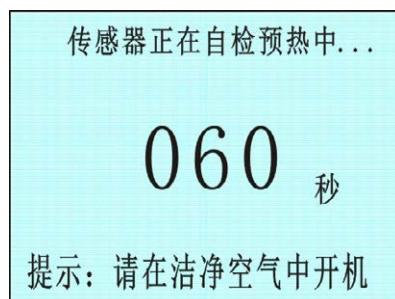
倒计时完以后进入测试界面，按“ENTER 键”可切换不同的显示模式，按“◀”键和“▶”键切换通道，如下图：
