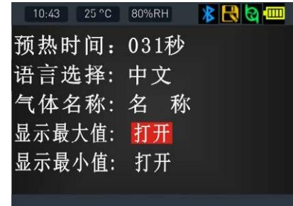
**显示最小值：**选择打开就在单通道界面显示本次测量的最小值和上次测量的最小值，如右图：
