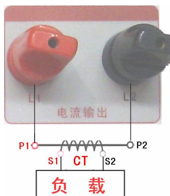
图 8、一次通流接线图
