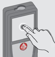
轻触显示屏以打开屏幕上的按钮或进行选择。轻触底线中间的图标以激活距离测量或启动摄像机。
