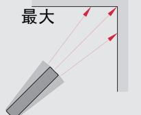
将显示测量的最小距离和最大距离（最小值和最大值）。上次测量的值显示在主显示栏。
