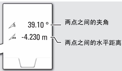
**i** 使用其他结果来测量两点之间的间接距离。适用于屋顶的长度与坡度、烟囱高度等测量应用。
