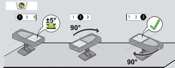
将装置顺时针旋转  $90^\circ$  两次。按照显示屏上的说明操作。当OK图标出现在显示屏上时，调平完成。
