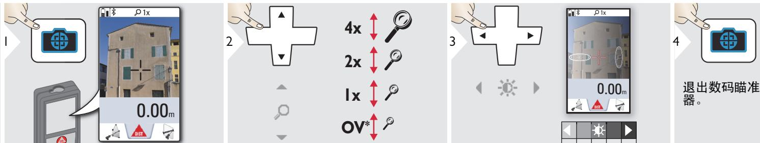
这对户外测量大有益处。集成数码瞄准器会在显示屏上显示目标。装置会在十字光标的中心进行测量，即使激光点不可见。
