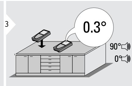
i 显示 360° 倾斜，横向倾角 +/- 10°。在 0° 和 90° 时仪器会发出提示音。适合于水平或垂直调整。
