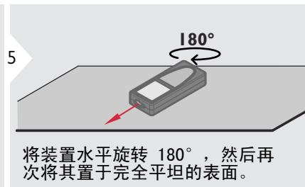
将装置水平旋转 180°，然后再次将其置于完全平坦的表面。
