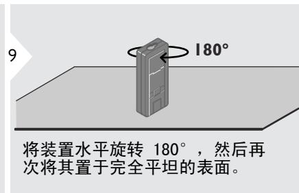
将装置水平旋转 180°，然后再次将其置于完全平坦的表面。
