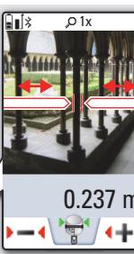
使用光标键或轻触显示屏以选择箭头，然后使用软键来调节。对应的图像圆柱测量会计算出来。
