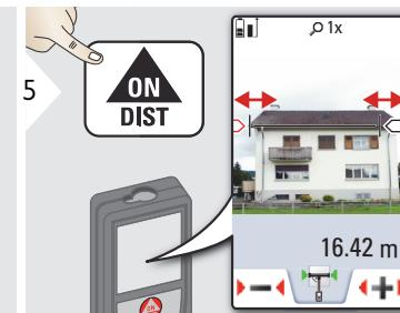
使用光标键或轻触显示屏以选择箭头, 然后使用软键来调节。对应的图像距离测量会计算出来。
