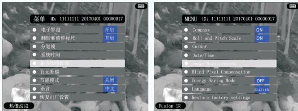
进入子菜单后通过上下键选择调整配准两个波段图像重合到一起为止（只能在Fusion IR或LL Channel模式下载使用）。
