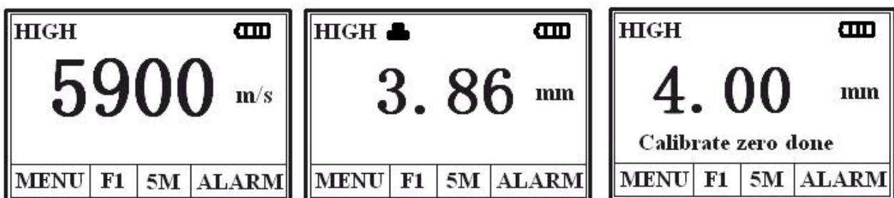
注意：每次更换探头后，探头温度、环境温度等工作环境发生变化后，或工作一段时间发现测量值有误差后，都应查看标准试块测值是否准确，若差别较大就要进行校零操作。
