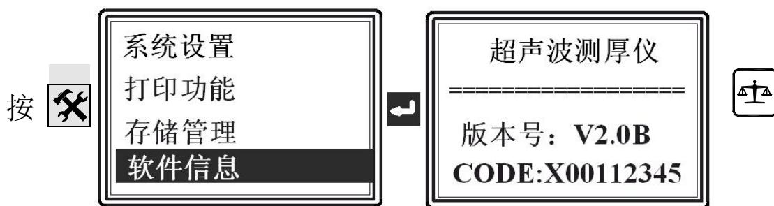
在软件信息的显示下按 键后仪器将恢复出厂设置的参数同时自动关机。
