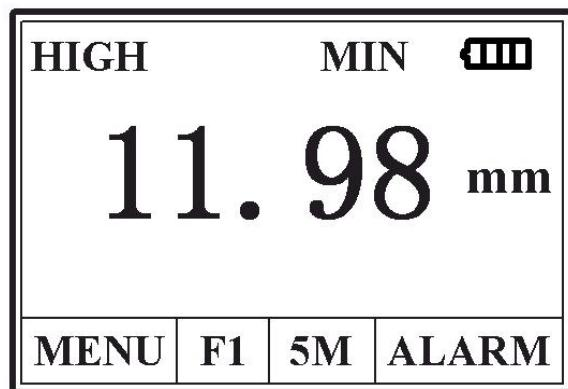
并且最小值标志 **MIN** 闪烁几秒，如果在 **MIN** 闪烁期间继续测量，前面的测量值将继续参加最小值捕捉，**MIN** 停止闪烁后再进行测量，重新进行最小测量值捕捉。
