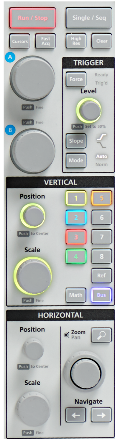
高效直观的前面板提供了关键控件，同时为 15.6" 大型高清显示器留出了空间。
