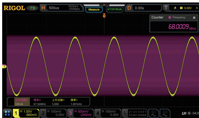
同时观察并准确测量两路频率相差很大的信号，全内存硬件测量可以在具有339.6k个上升沿的波形中测得准确的频率值
