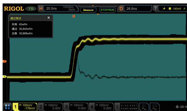
Pass/Fail 测试功能可以快速统计信号中异常发生的概率
