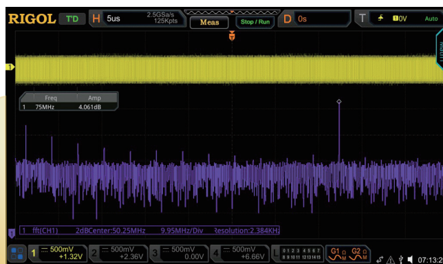
利用近场探头，可以很容易地观察到当探头靠近辐射泄露点时在频域上出现的频谱尖峰
