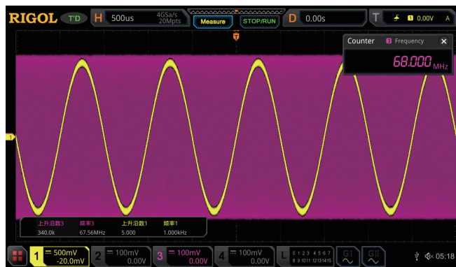
同时观察并准确测量两路频率相差很大的信号，全内存硬件测量可以在具有 340k 个上升沿的波形中测得准确的频率值
