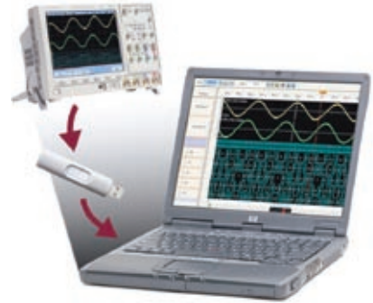
图 12. 在基于 PC 的离线工具上观察和分析先前获得的示波器数据
