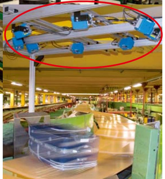
SICK ALIS行李辨識系統在行李分流過程中提供流暢的傳送速度。
