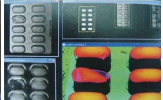
SICK Ranger E視覺感測器透過3D外型輪廓檢測藥片包裝缺陷破損的狀況
