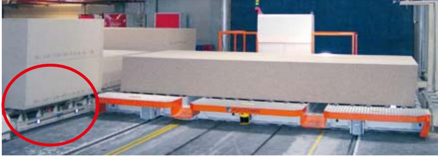
台車定位透過非接觸式感測方式、可自由穿梭移動，不受影響
