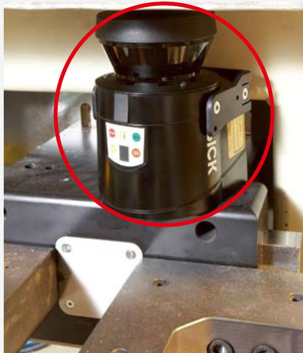
S100區域掃描器確保90個位置都放滿了轉向機柱以及指示機械手臂抓取工件的位置
