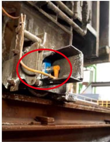
透過特殊的外殼材質及額外安裝的金屬防護罩，讓DT500距離量測器具備耐高溫的能力。
