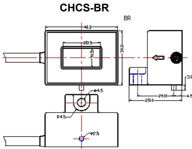
\*以上两种，连接器输出型号为 CHCS-BA；线输出型号为 CHCS-BR
