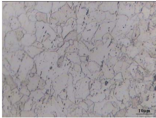
图 6 直流电处理钢丝的显微组织
