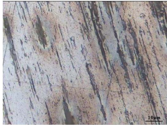
3 钢丝加工硬化态的显微组织
