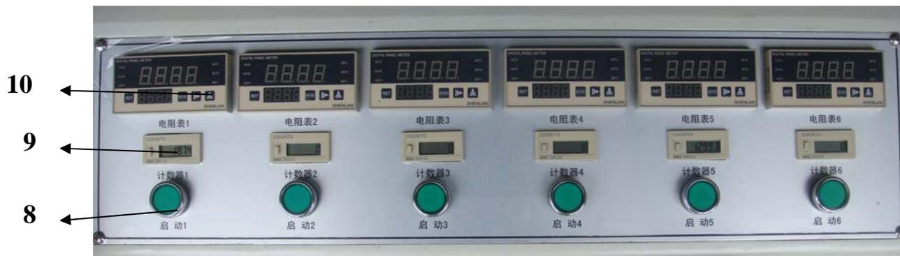
8. **启动开关与指示灯**：将试样固定后，电阻表会显示该产品实际电阻值，如阻值有偏差可参照电阻表设置进行修正。当电阻未超出设定范围时，按下启动键，同时该指示灯亮，如电阻超出设定范围则无法启动。
