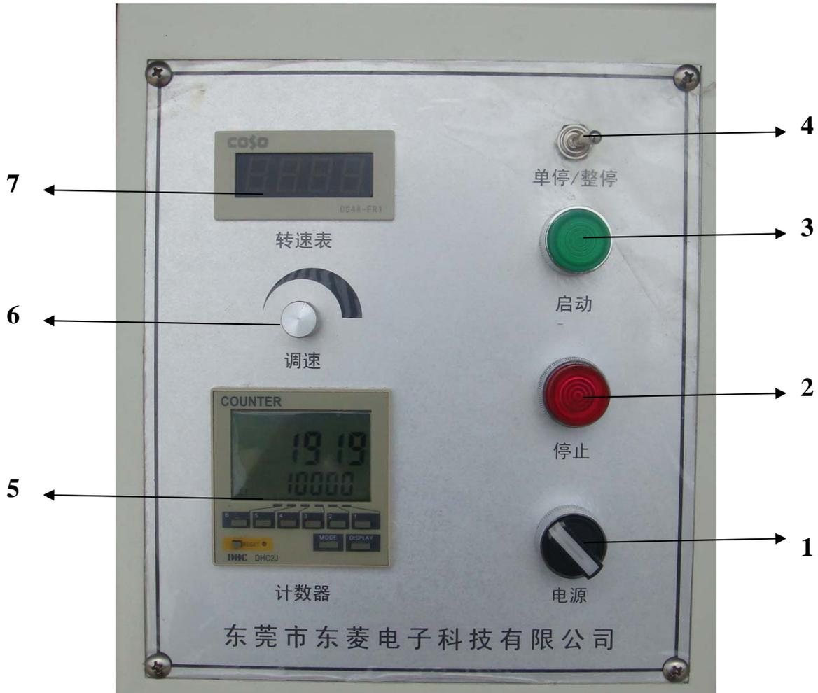
1. 电源开关：整机电源需通过此开关启动与关闭
