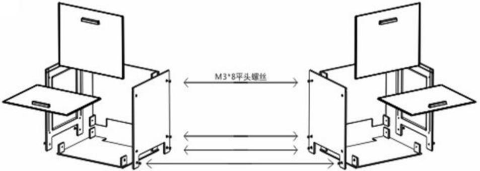
请参照组装图装防风罩组用螺丝锁好。
