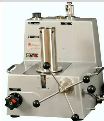
实施或中断标准产品与待测系统的运行，须采用防泄漏手动上紧快速连接器，该连接器配有压力驱动型密封件。所有控制元件均清晰标记、易于操作。标准产品的参考水平已在外罩正面的标签上注明。每个安装测试点都会内置一个铂电阻温度计来监控活塞温度。
