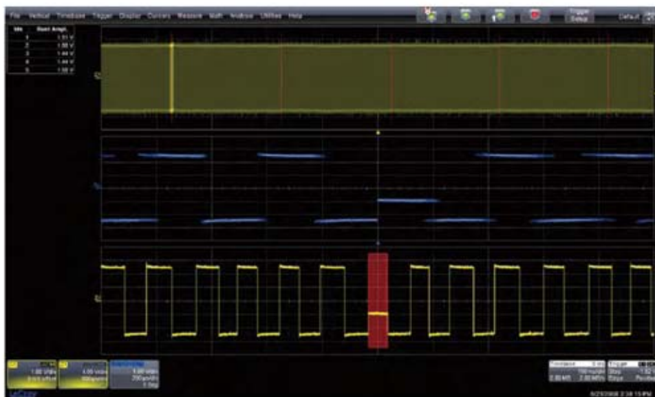
使用 WaveScan，找到 20 多种不同类型的特性。每种特性都在波形中高亮度显示，并列在表格中。从 Scan Table 中，可以直接跳到任何异常事件上，进行叠加检定。
