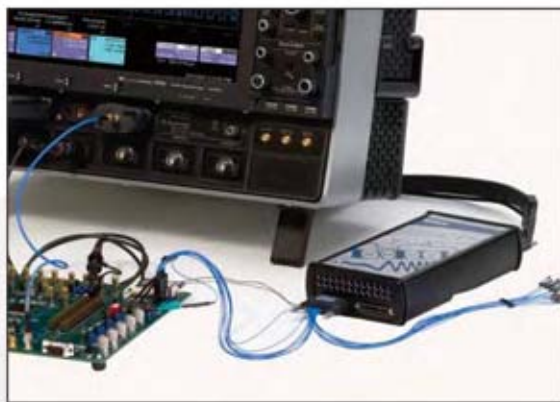
这两种 MSO 选项都增加了新的功能，可以把模拟信号和数字信号放到 4+36 码型触发中，实用地调试混合信号设计。
