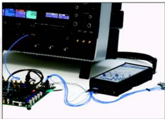
MSO选项都增加了新的功能，可以把模拟信号和数字信号放到4+36码型触发中，实用地调试混合信号设计。
