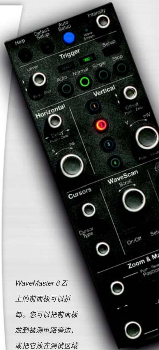
WaveMaster 8 Zi 上的前面板可以拆卸。您可以把前面板放到被测电路旁边，或把它放在测试区域远一点的地方。您只需把任何长度的标准 USB 2.0 电缆连接到前面板上，而不受标准示波器限制。
