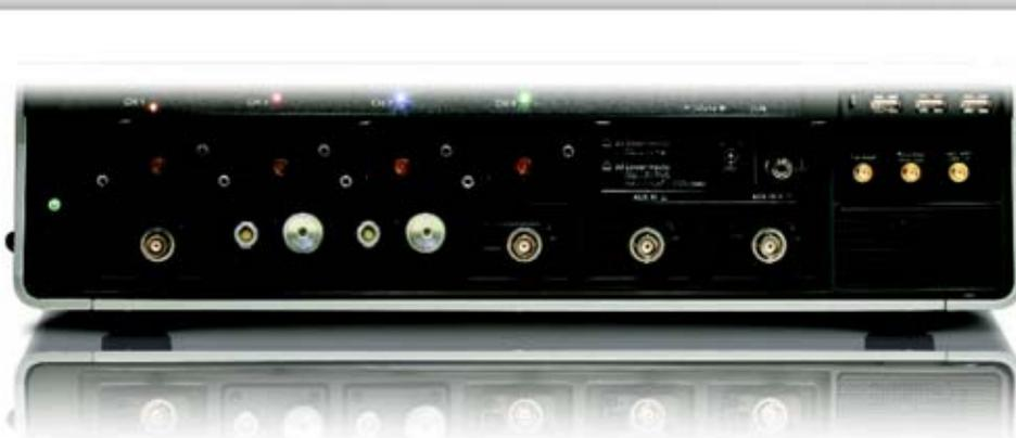
8个输入基本上可以复用到四条通道中，使探头重连数量减到最小，简化自动测试。
