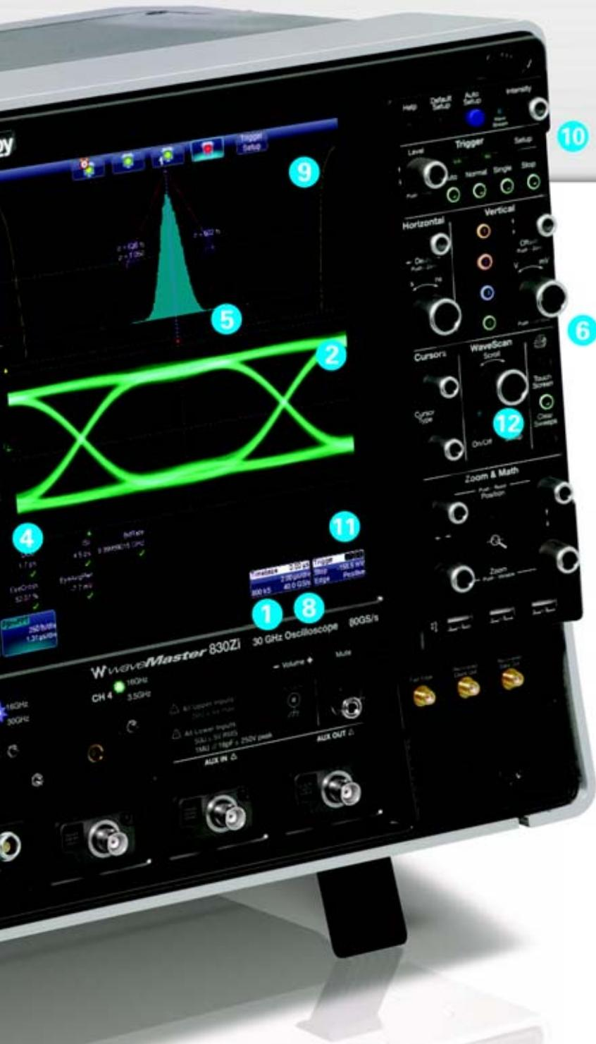
1. 业内领先的性能—30 GHz 带宽，80 GS/s 采样率，512 Mpts 分析存储器
