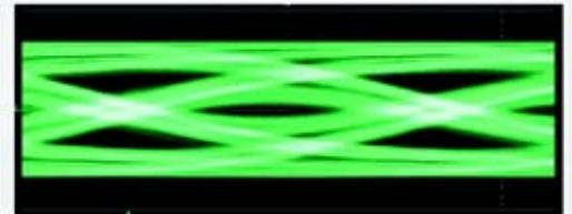
随着串行数据速率提高，背板中的衰减使接收机输入上的眼图“闭上”。
