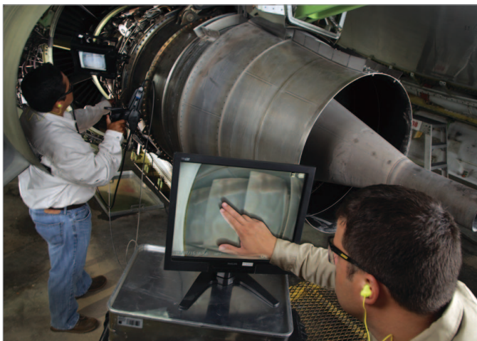
两个操作者可透过连接至 IPLEX RX 的外接显示器共享同一个检测影像来进行远端观测
