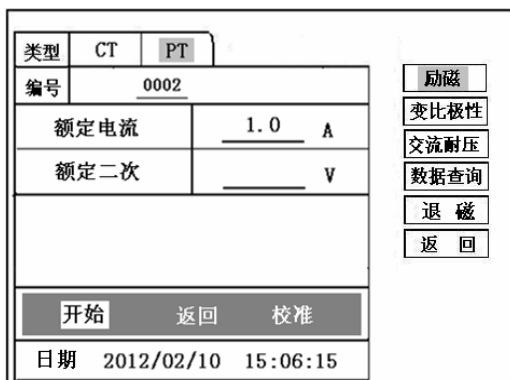
图 18, PT 励磁特性参数设置界面
