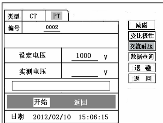
图 23, PT 交流耐压测试界面
