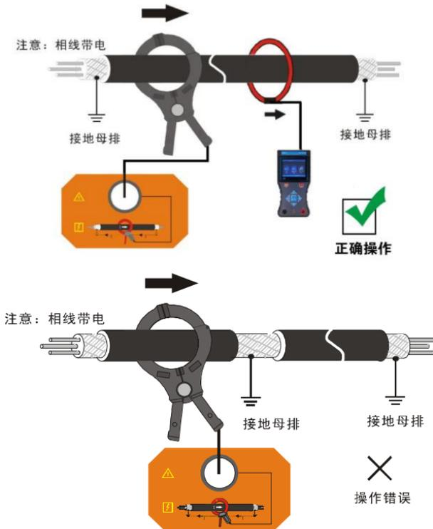
本方法适用于普通三相统包运行电缆的探测。发射机输出接卡钳，将卡钳卡住电缆本体（注意不能卡接地线以上部分），卡钳等效为变压器的初级，电缆金属护套 - 大地回路等效为变压器的次级（单匝），次级耦合
