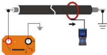
芯线和大地相接的方法使用较繁琐, 但目标电缆上的有效电流最大, 且不易受邻近电缆干扰, 若电缆绝缘好, 发射电流就更不会流到交叉的其他金属管线上, 所以在特别复杂的环境应优先采用本方法。
