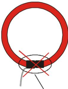
**注意：请勿将线缆靠近线圈接口处进行测量，以免造成误差。**
