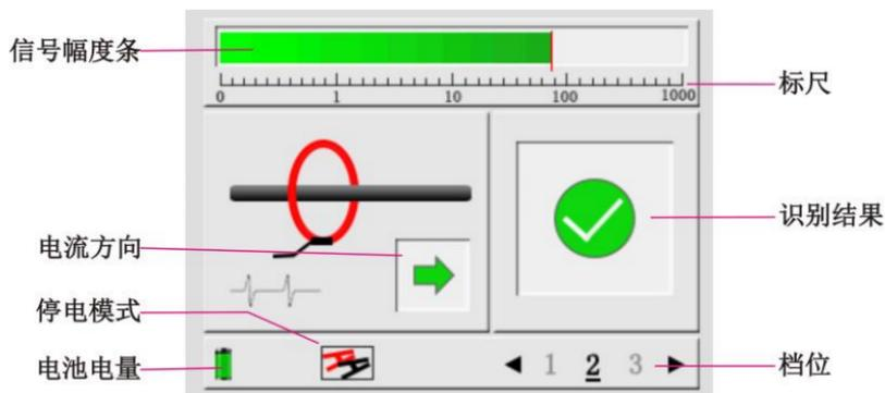
接收机进入“V/A test”电压电流测量界面，屏幕显示交流电压大小、交流电流大小、交流电流频率和电池电量信息。
