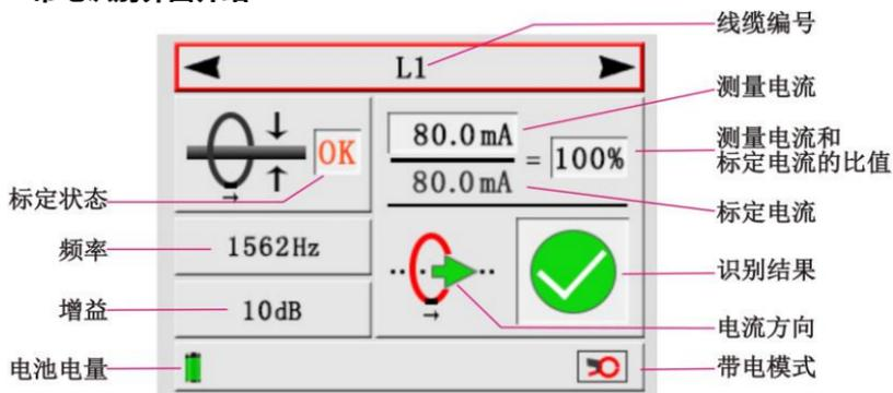
接收机进入“Poff cable test”停电电缆识别界面，屏幕上方方框显示信号幅度大小，左侧方框显示电流方向，右侧方框显示当前识别状态，下方方框显示增益强度和电池电量信息；按左右箭头键调节增益强度 1~3 档，第 3 档位信号放大最强。
