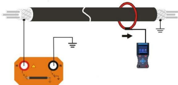
发射机电流流经屏蔽层，在远端的进入大地，再经过大地返回到发射机。同样，由于屏蔽层和大地之间存在电阻和分布电容，随距离的增加，电流会逐渐减小。
