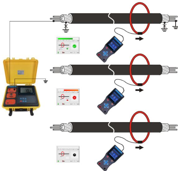
在进行带电识别或停电识别，不要将柔性电流钳的线圈接口处靠近线缆进行测量，以免造成误差
