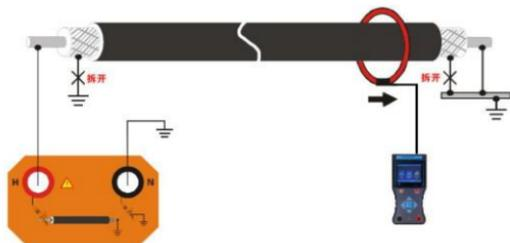
**如果目标电缆没有铜屏蔽和铠装, 请按照下面的图示接线:**
