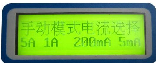
按“复位”键，循环选择 5A、1A、200mA、5mA，闪烁的字幕表示当前选择的电流档，再按“启动”键，表示确定了之前的选择，并开始消磁。仪器手动消磁一共有 4 种，分别为：5A 标准消磁、1A 标准消磁、200mA 标准消磁、5mA 标准消磁
