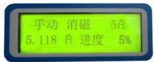
B、若最初选择的是自动模式，上一步操作结束后再按“启动”键，开始自动消磁过程，系统自动按照 5A、1A、200mA、5mA 的顺序进行消磁。
