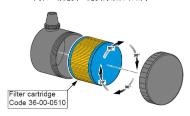
如右图 A 处是空气过滤器的地方,按上图的方法,顺时针旋下空气过滤器的盖子,拿出旧的过滤器,(如右图 B 处),放入一只新的过滤器后,盖上盖子。
