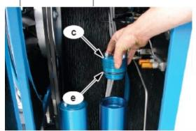
然后用手扣住过滤器的拉环,拔出过滤器,并装入新的过滤器后,重新将过滤筒的盖子 C拧紧。
