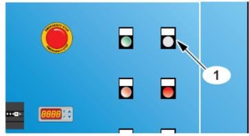
接好电源并供电后,按启动按钮不能 启动,并且转向警告灯(2)亮起, 表示接线相序错误,需要改变相序。
