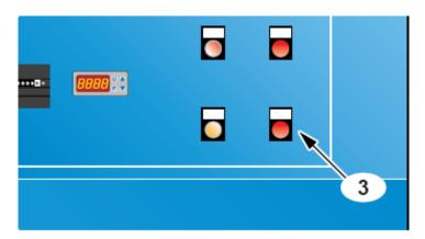
当转向警告灯与油位警告灯都熄灭后,电源灯亮起,即可按启动按钮(4)即可启动压缩机,如右图所示。
