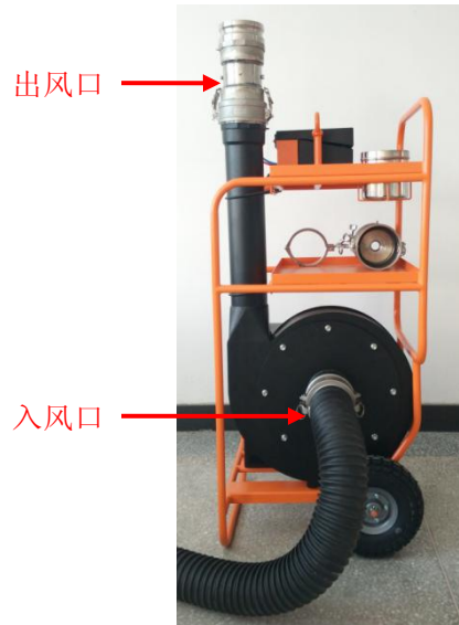
高流量管道负压测试
