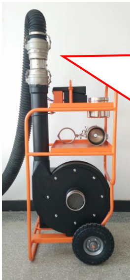
高流量管道正压测试
