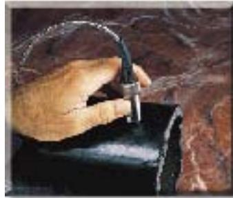
忘掉那些消磨时间的除去涂层的工作吧。DMS 2TC的TopCOAT功能不仅能帮你测量母材的厚度，还能同时测出涂层的厚度。此外，你在某些情况下也能透过涂层测量厚度。比如通过回波测量（复合双晶测量功能）
