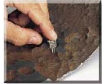
拥有微型接触面的特殊探头能测量那些难以接近凹点的残余壁厚：构件由于严重腐蚀引起的严重凹坑或坑洼的表面。
