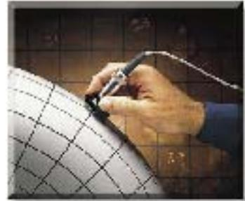
使用Auto-V功能，你能立即测量未知材料声速—不需要任何预先校准测试！其它的优点：由于温度变化引起材料声速变化所造成的测量错误—比如塑料材质—或由于不均匀材质—比如灰口铸铁—都可以排除；加强了测量可靠性
