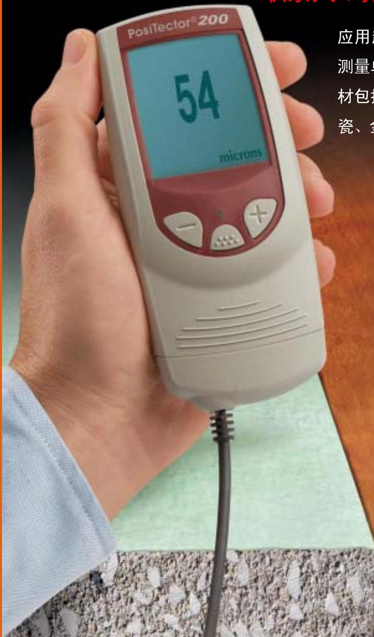
应用超声波技术，可容易、准确地测量单层或多层涂膜的厚度。适用基材包括混凝土、木材、塑料、玻璃、陶瓷、金属以及其它很多材料。
