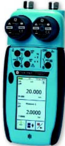
可换量程双通道压力校验仪，量程从 2.5 kPa ~ 100MPa
