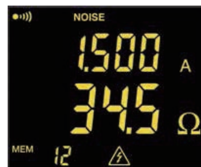
在任何（标准或高级）测量模式下启用对地电压功能
