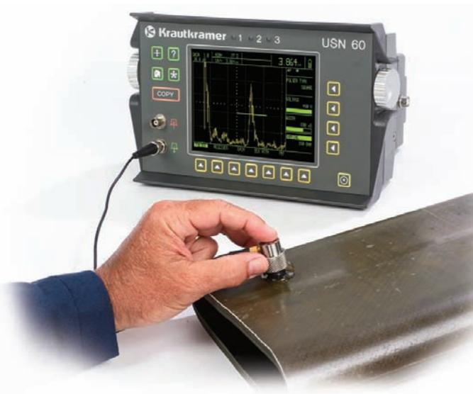
可调脉冲宽度的方波脉冲发生器应用于复合材料测试。
