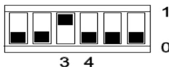
进行更换时，在打开传感器电源之前，需要使开关3处于上方“1”位置。开关4处于下方“0”位置时，可以更换传感器。
