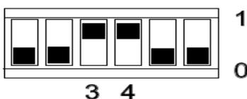
开关4处于上方“1”位置时，可以更换辅助电子装置。更换电子装置时，在打开传感器电源之前，必须将其移到本位置。
