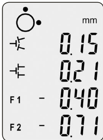
图25. 动态显示水平方向的对中
