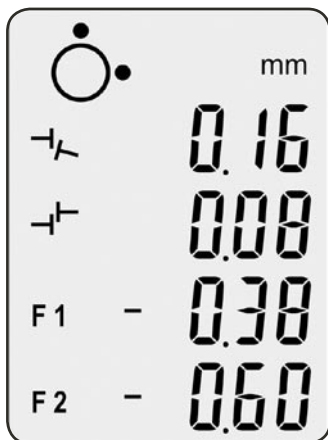
图21. 显示垂直方向上的对中情况
