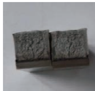
★图二 冲击试验断口面
