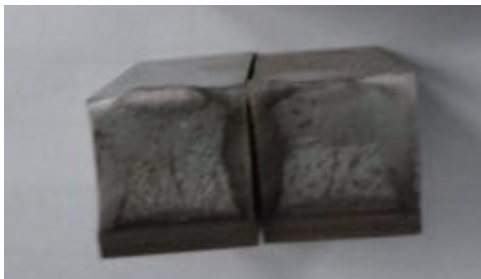
★图三 第二批冲击试样的断口
