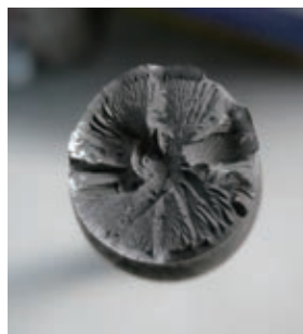
★图一 拉力试验断口面
