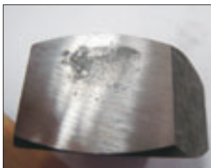
图十一：六角螺母裂纹
