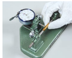
丸物の振れ測定为例です ワーク
