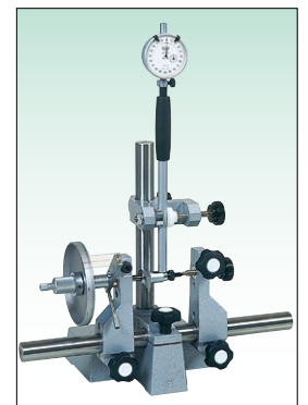
使用例 シリンダゲージの検査
