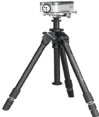
除非您使用的是专用的测量台，否则您可能需要一个三脚架和云台用于调节激光相对于待测轴的位置。新型通用三脚架已经过广泛的测试，具有稳定的可调基座，而且结构小巧、轻便。
