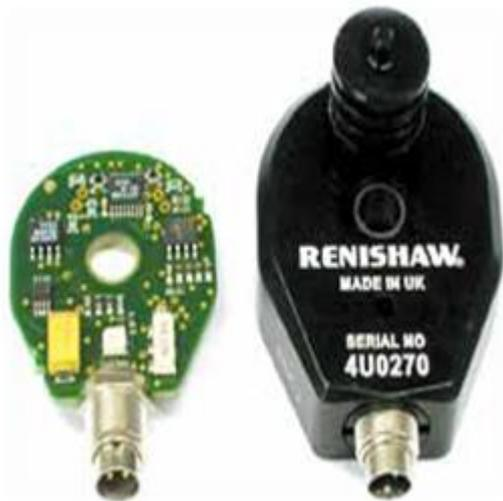
XC-80 补偿器是 XL 系统测量精度的一个关键因素。补偿器配备有“智能型传感器”来处理原始环境参数，可非常准确地测量空气温度、空气压力和相对湿度。传感器电缆长 5 m，可拧下，更换方便在较长机器上测量时，可用螺旋接头将多条电缆接在一起而加长。
