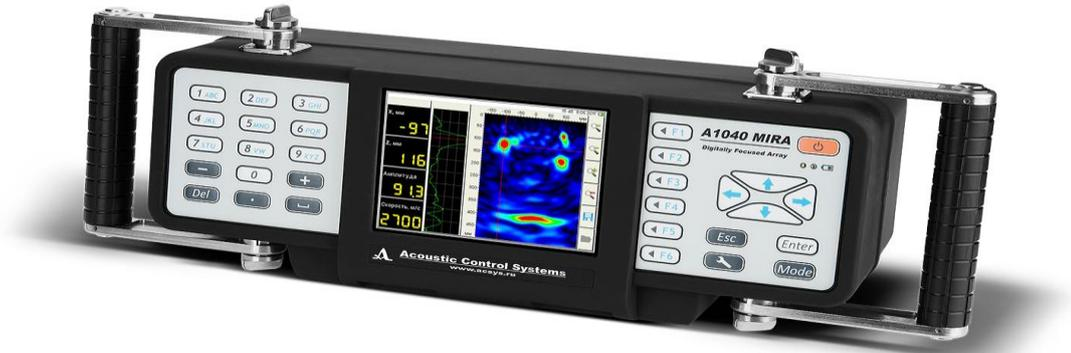
A1040MIRA 混凝土断层、缺陷超声波检测仪是一部多功能超声基阵无损检测仪器。通过 48 (4×12) 个陶瓷耐磨低频宽带横波干点接触的传感器矩阵，利用脉冲回波技术和合成孔径聚焦技术组合探测，针对混凝土、钢筋混凝土和石材进行内部成像，用以检测其内部的夹杂物，空腔，裂纹，裂缝，蜂窝，预埋管道等，也可以用来测量厚度、评估混凝土的强度，可测量厚度达 2 米。
