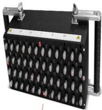
48 个（12 排每排 4 个）陶瓷耐磨低频宽带横波干点接触式传感器矩阵，额定工作
