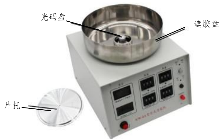
图 2 匀胶机安装示意图
