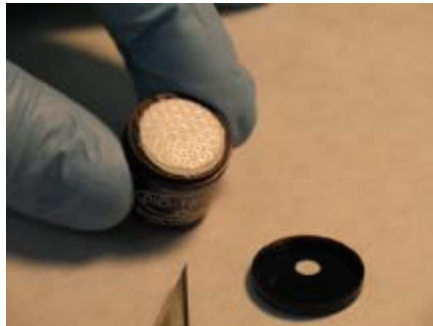
图7-5. 拆卸过滤介质
