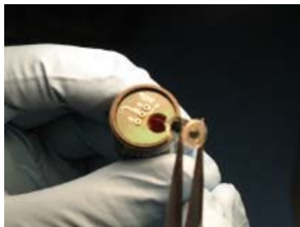
图7-10. 安装灯到传感器里
