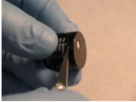
图7-4. 拆卸过滤器盖
