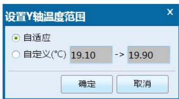
**Y 轴范围：**设置温度曲线 Y 轴范围，自适应为自动根据当前已经采样的温度的最小和最大值设置 Y 轴范围，以保证所有数据能正常显示。自定义则是用户自己设置 Y 轴范围。
